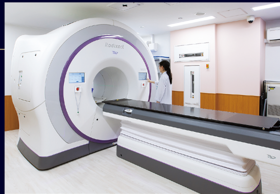
昨年6月に導入した高精度放射線治療装置。360度すべての方向を使って、広い範囲に強度変調放射線治療を行なうことができる。より確実にピンポイントの治療を提供することが可能であるため、副作用を減らす効果が期待できる。
