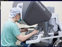
患者と同室内に設置されたサージョンコンソールで、高倍率・高画質の3D画像を見ながら行なうロボット支援手術。アームについている鉗子やカメラを遠隔操作しての手術で、腹腔鏡手術に比べて、さらに出血が少ないのが特徴だ。
