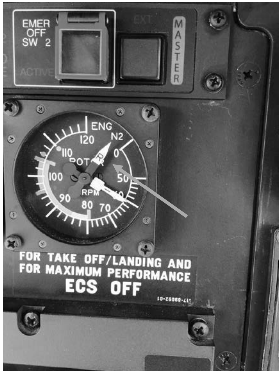
三針回転計と不具合再現状態 「R」指針が0以下を指し不作動。 (操縦席計器盤)
