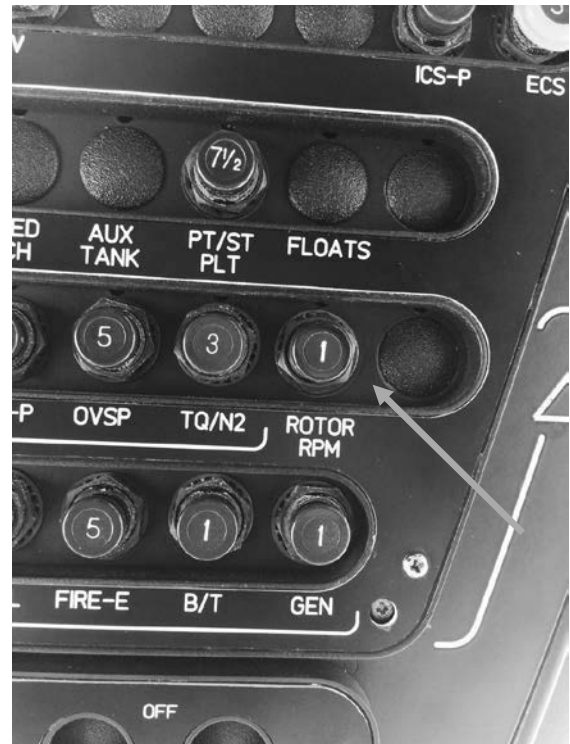
交換したサーキットブレーカー「ROTOR RPM」 (操縦席上方、オーバーヘッドパネル)
