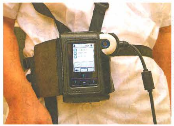
小腸カプセル内視鏡から送られる画像データを受信・記録する装置
